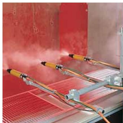
Fixation du pulvérisateur d'un appareil de revêtement par poudre. Grâce au poids réduit de la fixation, les inerties sont minimales. Les éléments sont bons conducteurs du courant électrique.
