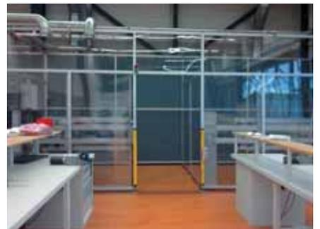
Portes de sécurité de la salle d'essai
