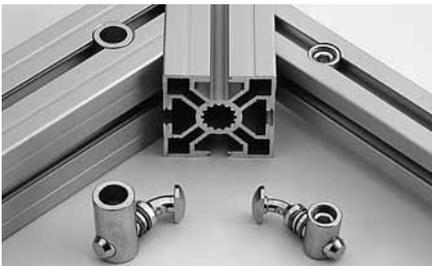
La tête d'ancrage recourbée à  $-15^\circ$ ,  $30^\circ$  et  $45^\circ$  à gauche ou à droite – ou avec une tête articulée permet de réaliser facilement des assemblages dans presque tous les angles.
