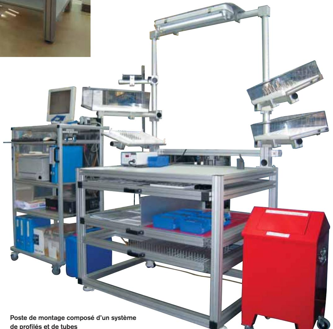
Poste de montage composé d'un système de profilés et de tubes
