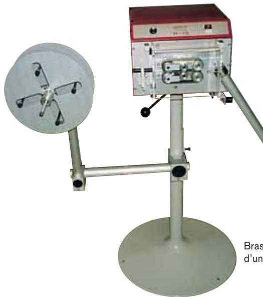
Bras orientable avec support de rouleau de câble d'un automate de dénudage.
