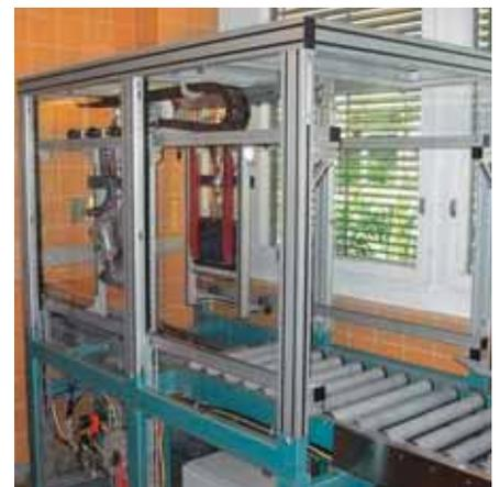
Carénage d'un dispositif d'empilement pour la stérilisation
