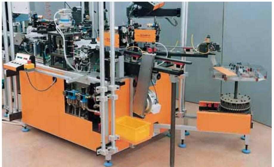
Glissière pour revêtement de protection d'un automate de montage avec équilibrage de poids dans les tubes aluminium.
