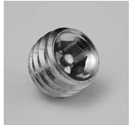
Vis spéciale PVS® Safe M12x12 destinée aux constructions de sécurité indémontables pour toute personne non autorisée. Une broche empêche le desserrage de la vis à l'aide d'une clé Allen courante.
