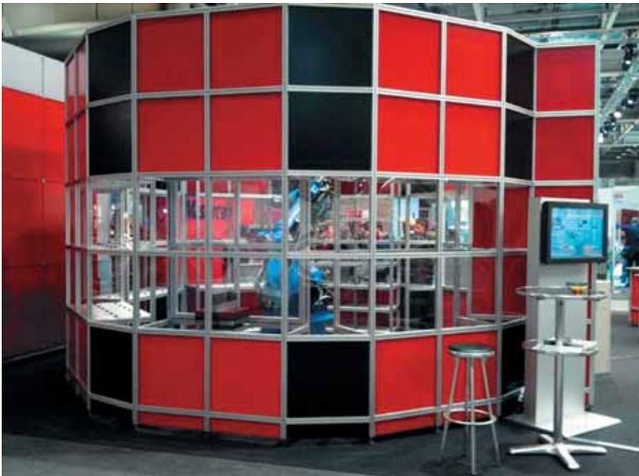
Cellule de protection et râtelier de stockage autour du robot
