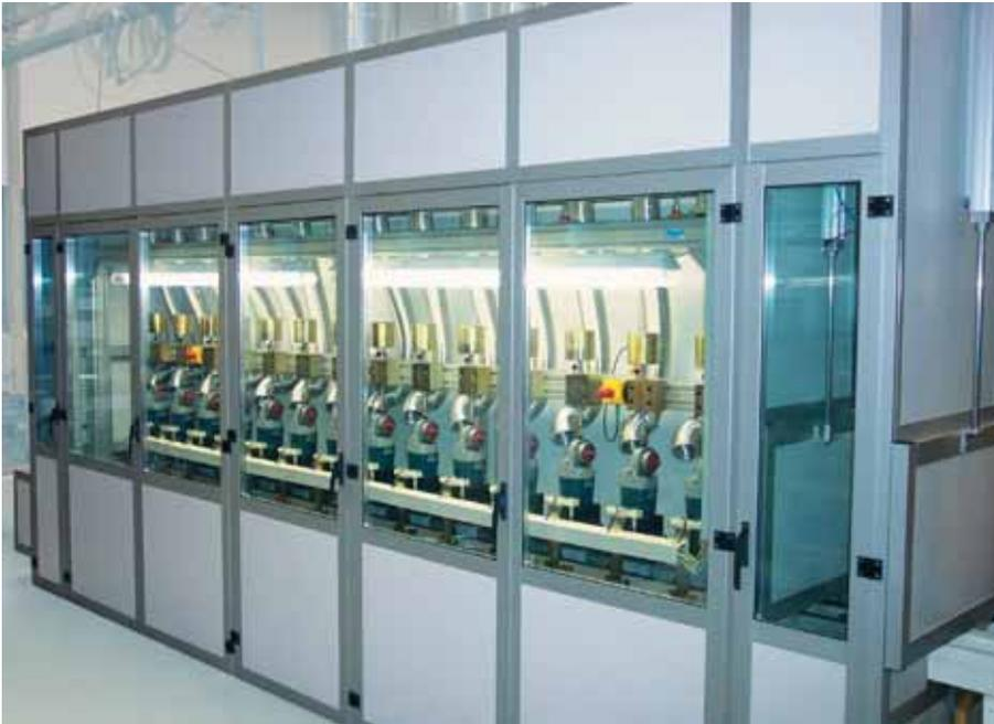
Banc d'essai d'endurance pour grandes meuleuses d'angle avec sas anti-bruit
