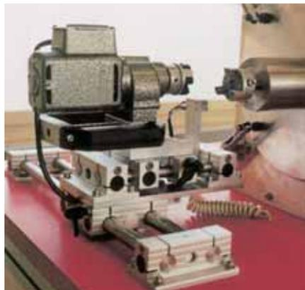
Commande d'accouplement et désaccouplement d'une unité de réglage X/Y pour tambour de microrevêtement. Moteur électrique en position de désaccouplement.
