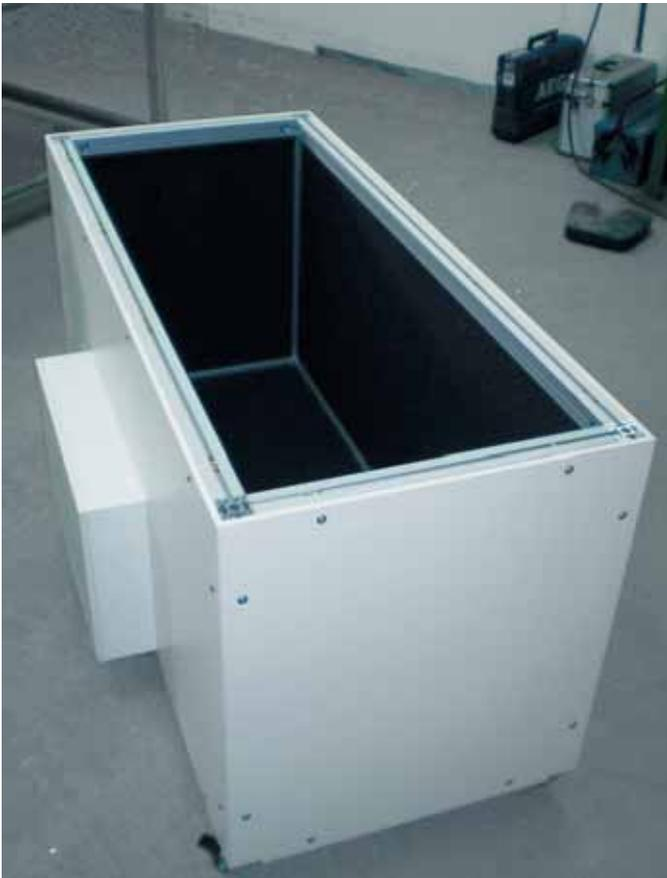
Logement anti-bruit mobile pour système de ventilation d'une pompe à vide
