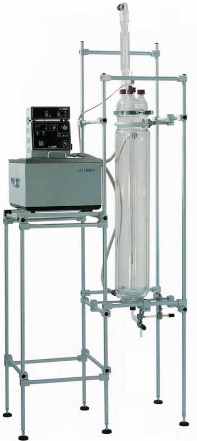
Réacteur à colonne à bulles pour réactions en phases liquides et gazeuses avec équilibrage de températures et dispositif d'absorption des gaz.
