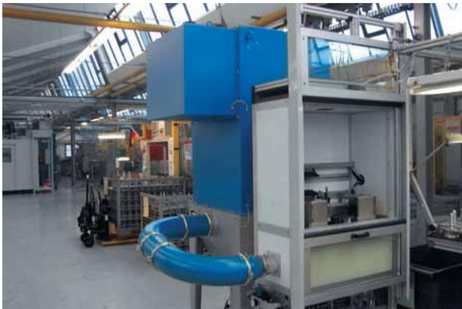
Cabine anti-bruit pour l'installation de nettoyage de pièces
