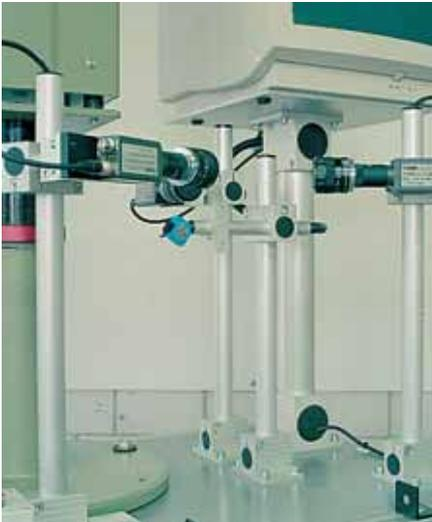
Dispositif de logement d'appareils de contrôle optique.
