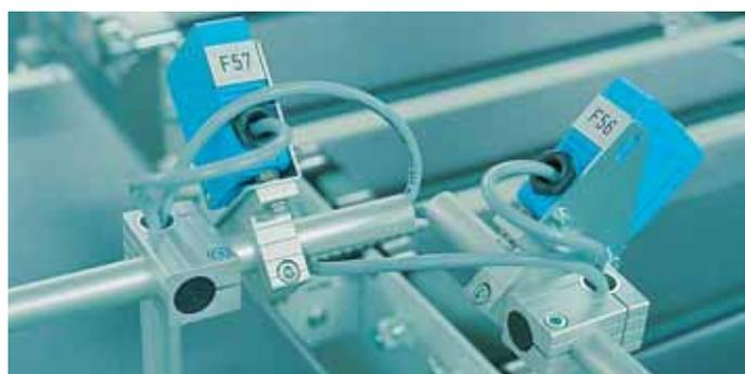
Fixation de cellule photo-électrique aisément ajustable.
