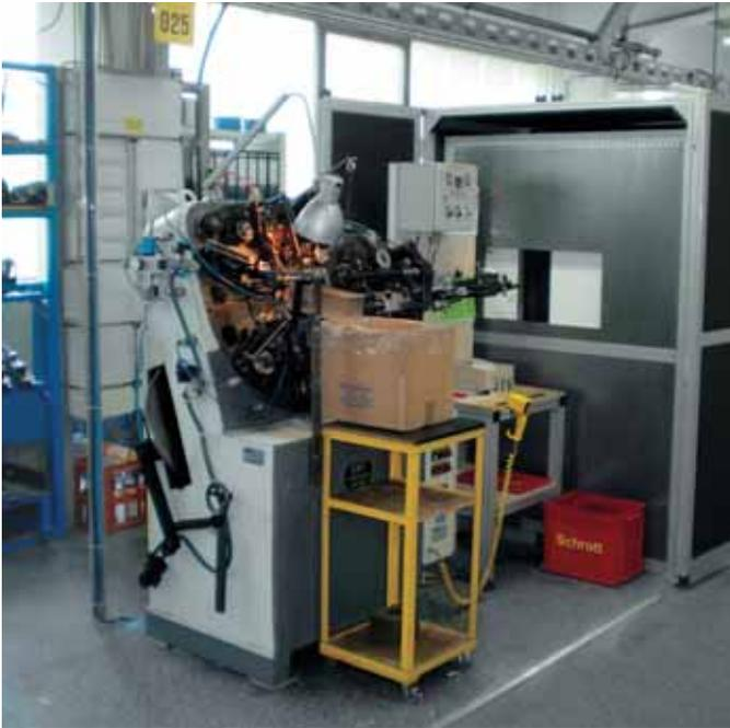
Cabine de protection acoustique sur rails, ouverte ou fermée
