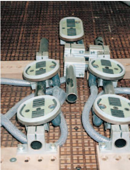
Anpassbare Vakuumteller für die Bearbeitung verschiedener Stuhllehnen.
