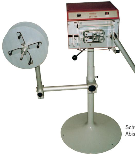
Schwenkarm mit Kabelrollenhalterung zu Abisolierautomat.
