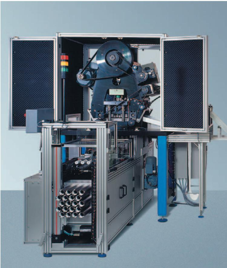
Stanzautomat mit Schallschutzhaube
