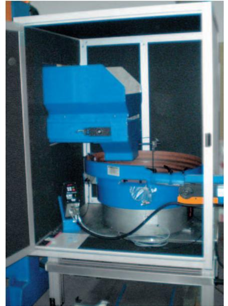
Lärmschutzverkleidung für Vibrationsförderer
