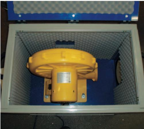
Schallschutzkasten für Gebläse
