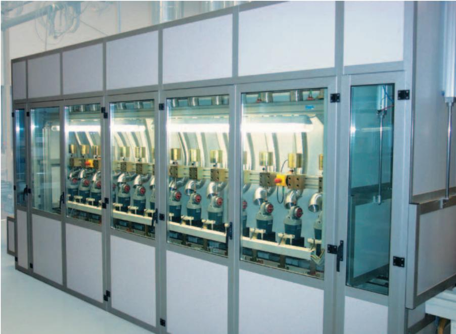
Dauerlaufprüfstand für 2-Hand-Winkelschleifer mit Lärmschutzschleusen
