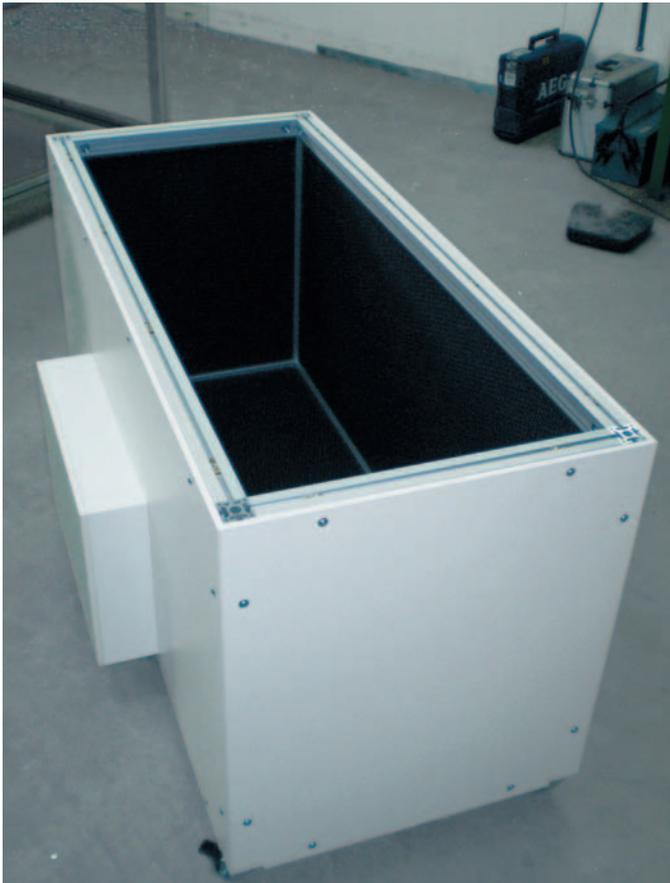
Fahrbares Lärmschutzgehäuse mit Lüftungssystem für eine Vakuumpumpe
