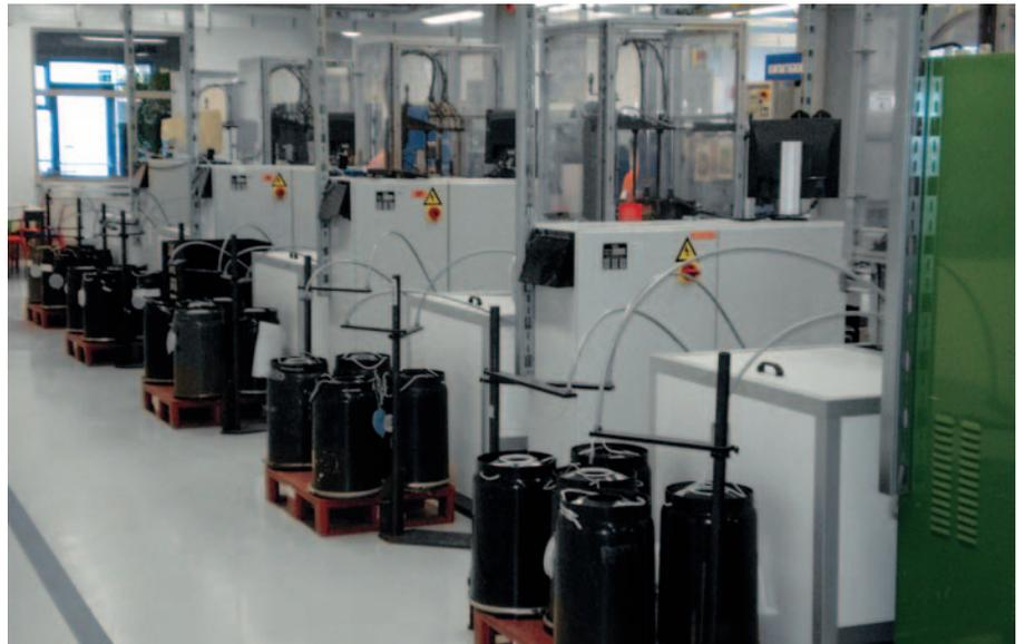
Lärmschutzverkleidung für Wickelmaschinen
