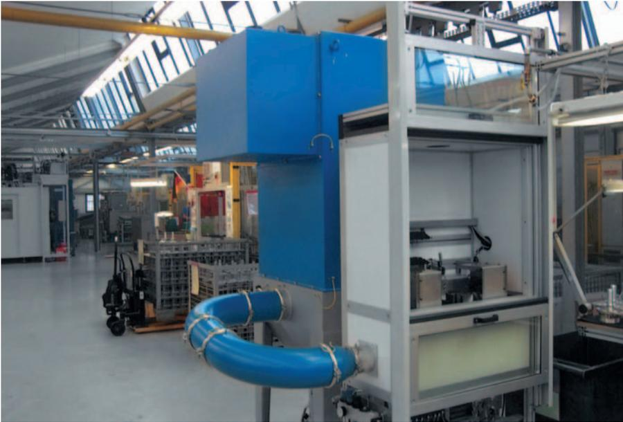
Lärmschutzkabine für Teile-Reinigungsanlage
