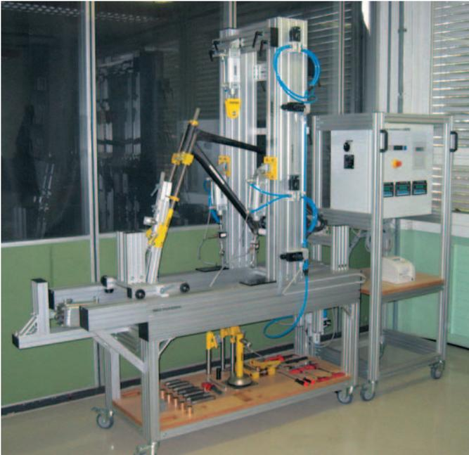
Prüfstation für Karbon Fahrrad-Rahmen
