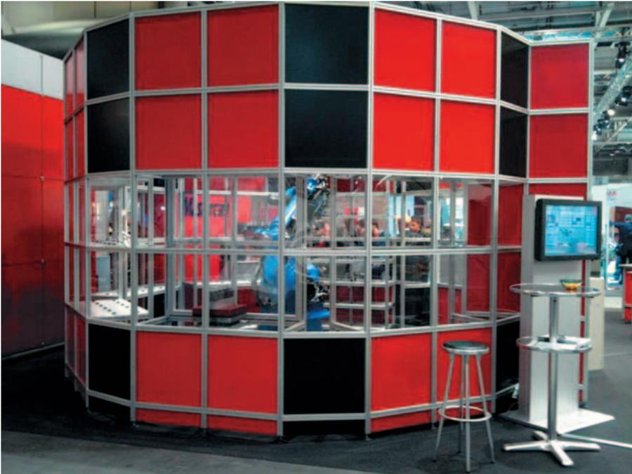
Schutzzelle und Lagergestell um Roboter
