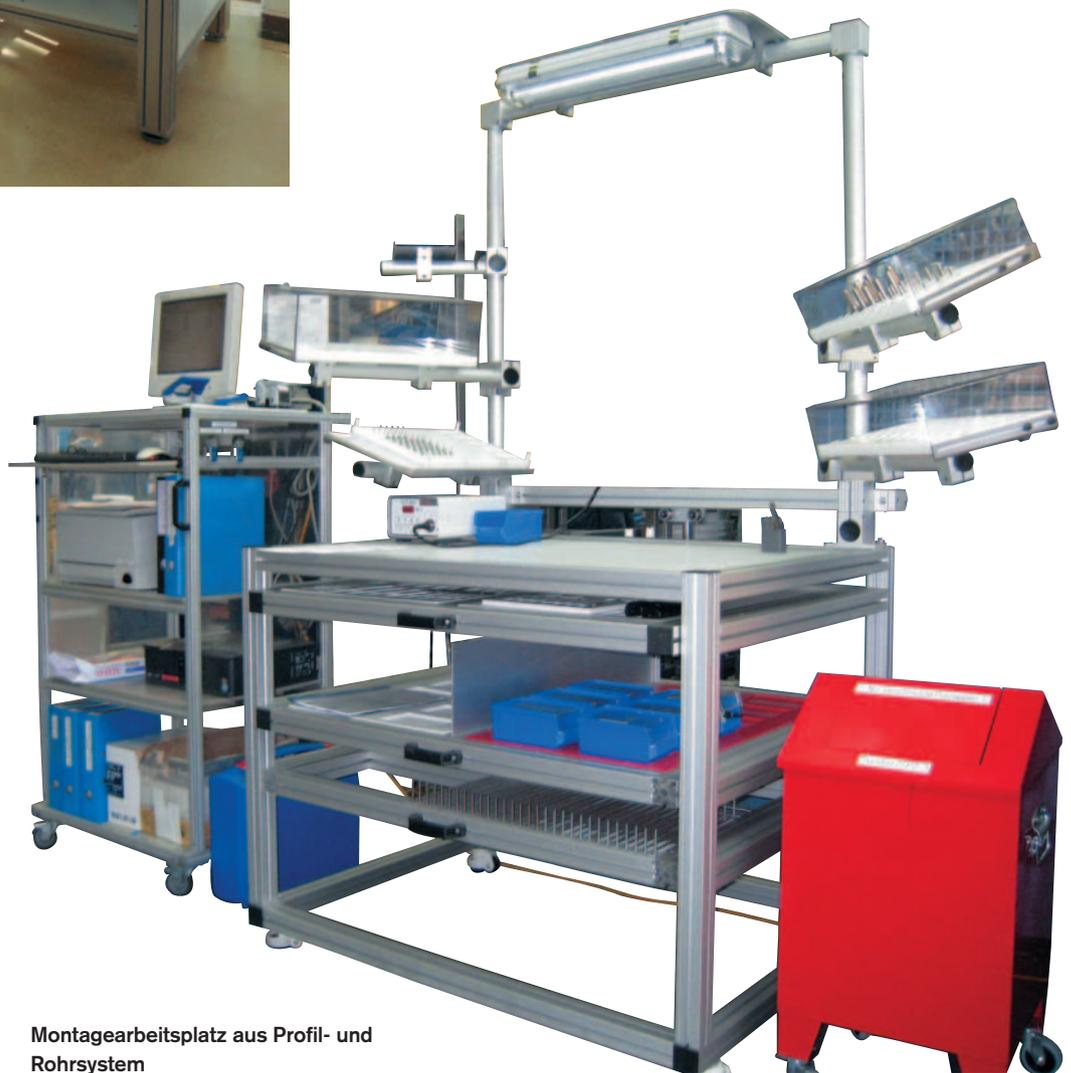
Montagearbeitsplatz aus Profil- und Rohrsystem
