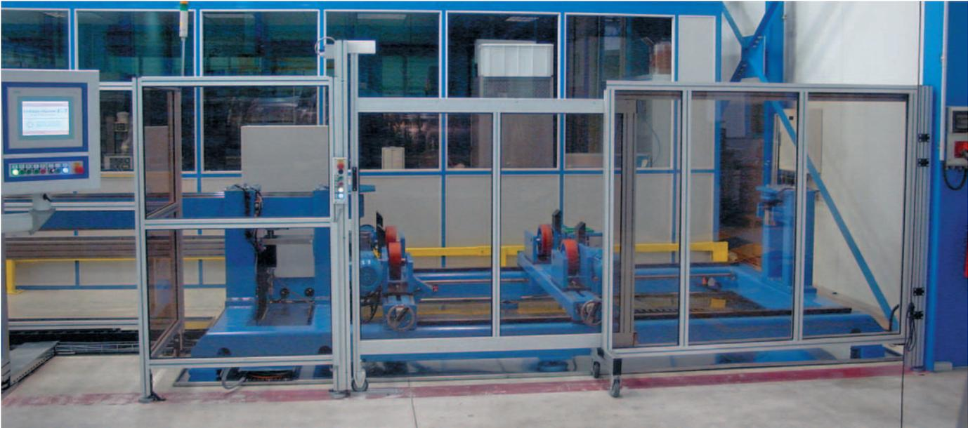
Verschaltung für Entgratungsanlage mit Sicherheitsglas
