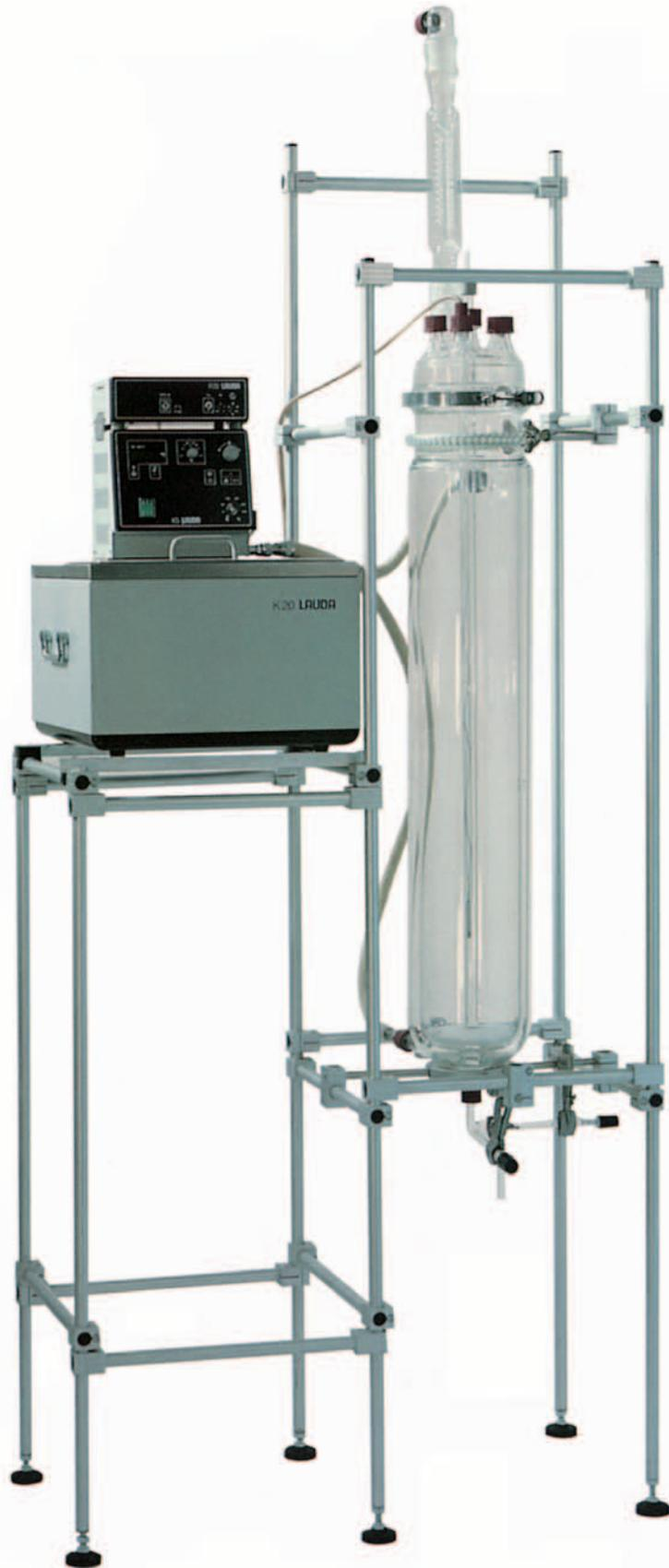
Blasensäulenreaktor für Flüssig-/Gasphase-Reaktionen mit Temperiermantel und Begasungseinrichtung.
