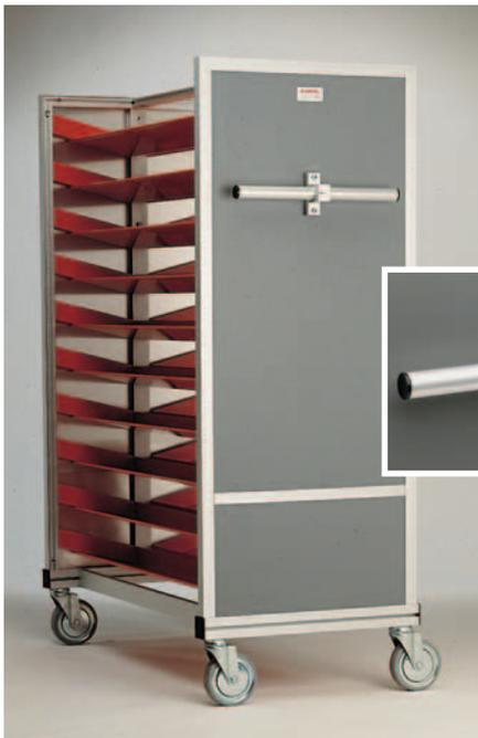
Zieh- und Stossvorrichtung an Material- und Magazinwagen für die Telefonmontage.
