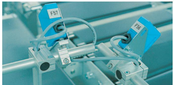
Fotozellen-Befestigung leicht justierbar.
