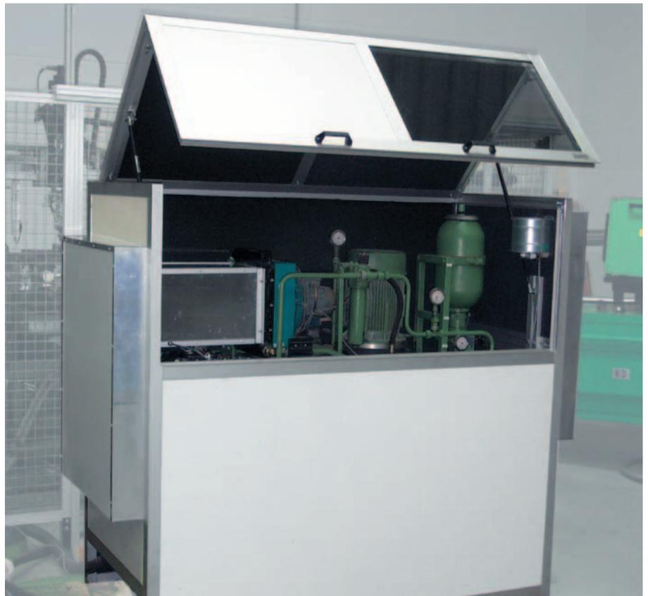
Lärmschutz für Hydraulikaggregat
