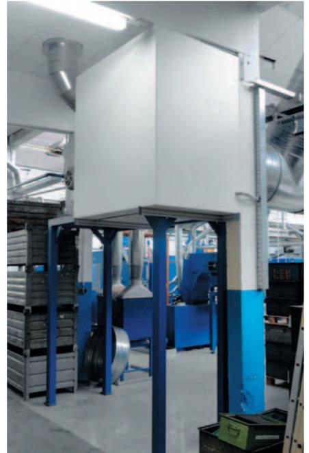
Halboffene Lärmschutz-Teilverkleidung Wärmetauscher
