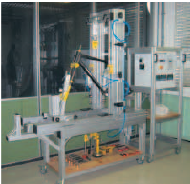
Dispositif de test pour cadres de vélos carbone
