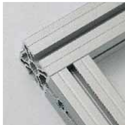
3. Introduzca y gire el cabezal del anclaje en la ranura longitudinal del otro perfil, apriete el prisionero. – Listo
